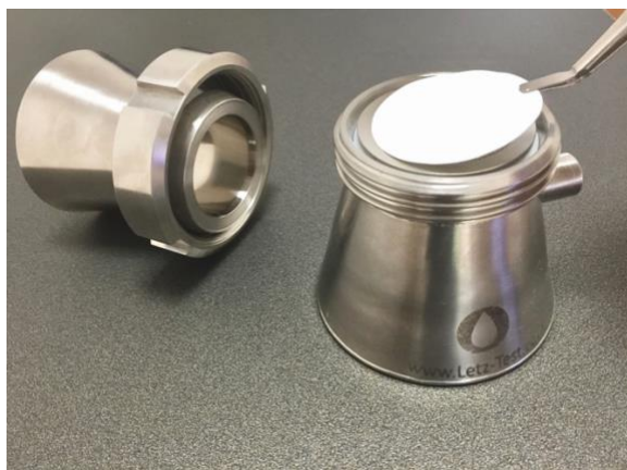
Figure 3 – Centrer un filtre membrane avec la pince préalablement stérilisée sous la flamme puis assembler l'unité de filtration.
