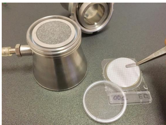
Figure 5 – Oter le godet et placer le filtre membrane dans la boîte de culture correspondante à l'aide de la pince à nouveau stérilisée sous la flamme.
