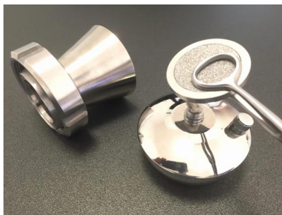
Figure 2 – Stériliser le godet et le support de filtre de l'unité de filtration à l'aide des forceps préalablement stérilisés sous la flamme.
