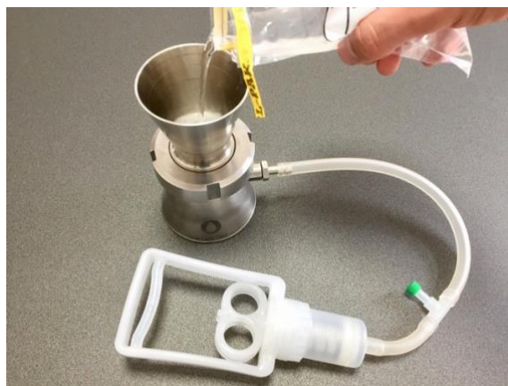
Figure 4 – Verser l'échantillon dans le godet jusqu'à la marque des 100 mL puis l'aspirer à travers le filtre membrane à l'aide de la seringue.
