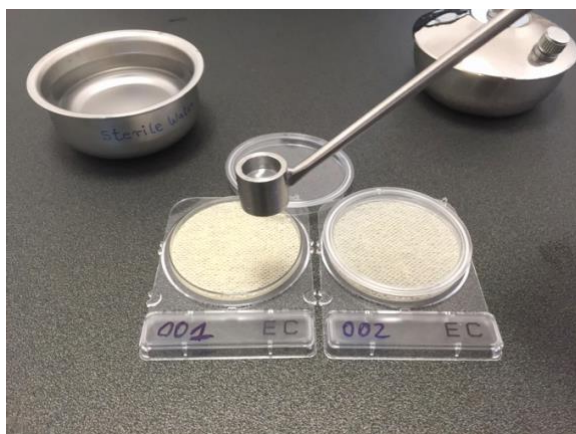
Figure 1 – A l'aide de la cuillère inox préalablement stérilisée sous la flamme, activer plusieurs plaques de culture avec 1 mL d'eau stérile.
